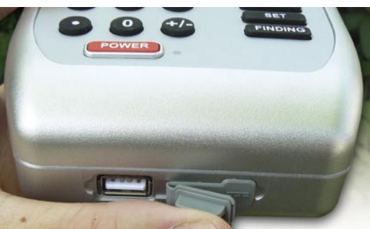
USB konektor pro připojení zařízení k PC vedle přípojky pro napájecí zdroj
