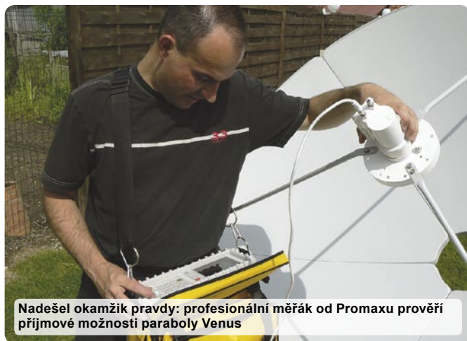
Jaké LNB? PT Subur Semesta dodává jejich paraboly s důležitým redukčním kroužkem. Můžete tak snadno vyměnit C pásmové LNB za běžné Ku pásmové.
