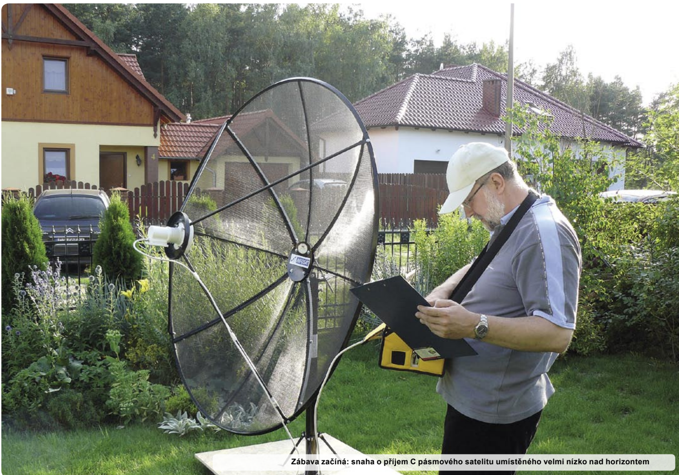
Čas nastavit anténu. Doporučujeme použít vodováhu vybavenou úhlověrem – ztlačení to usnadní nastavování elevace.
