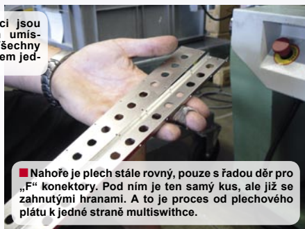
■ Kam se dává deska plošných spojů? Samozřejmě do kovové krabičky. A kde se tyto krabičky berou? V tomto výrobním stroji, kde je role ocelového plechu 36 cm širokého a 0,7 mm silného s 0,02 mm silným niklováním. Celá role váží skoro 100 kg a skrývá v sobě na 400 m plechu.
