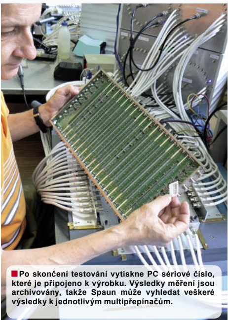
■ Každý multiswitch je testován na řadu funkcí. Multiswitch se připojí k této testovací stanici a pohybem jediné páky jsou všechny „F“ konektory zapojeny a testování může začít.
