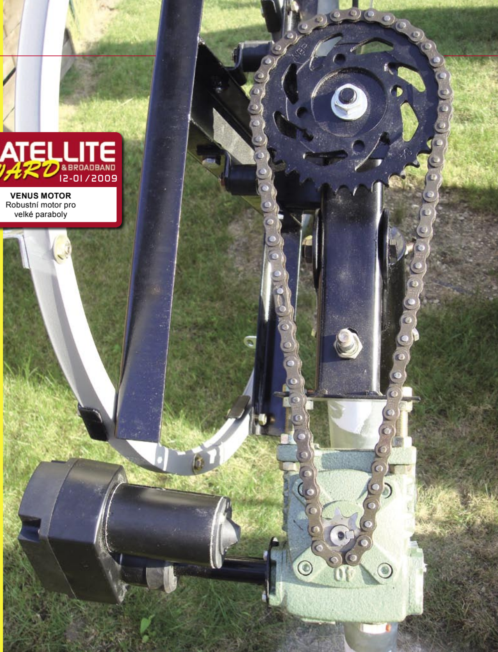
■ Motor od PT. Subur Semesta s řetězovým rozvodem z převodovky k ose
