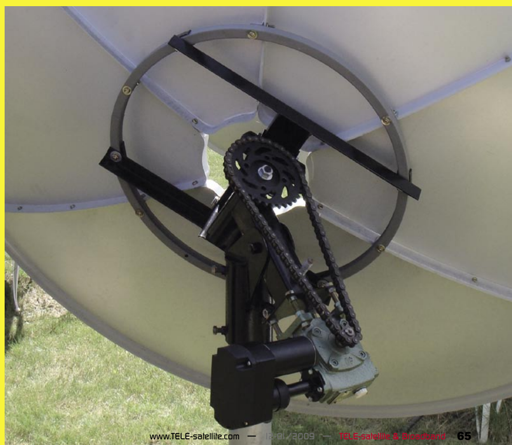
■ Motor od PT. Subur Semesta s řetězovým rozvodem z převodovky k ose
