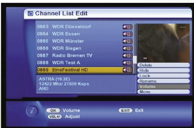
Úprava původní úrovně zvuku v seznamu stanic |
