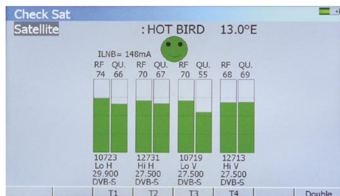
Identifikace satelitu založená na 4 předdefinovaných transpondérech
