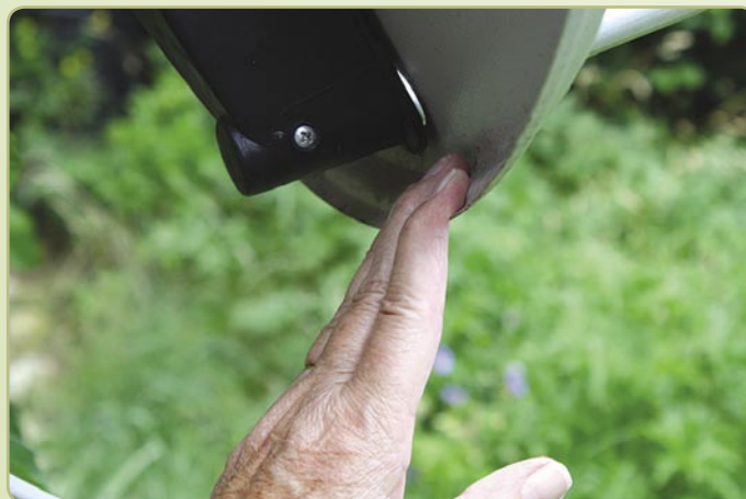
■ (Obrázek 4) Stranové nastavení paraboly
