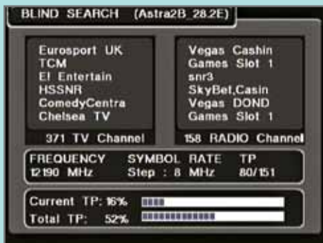
Funkce ladění naslepo umožňuje nalézt transpondéry, které nejsou součástí předuložených dat |
