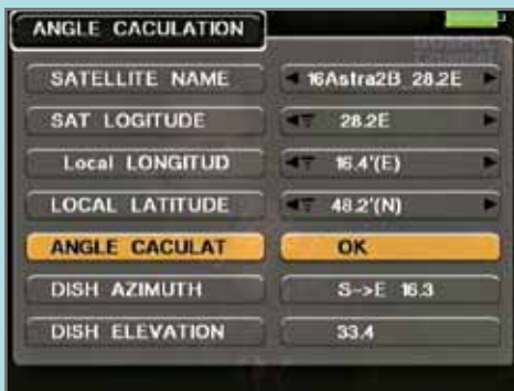
Vypočet úhlu zjednodušuje instalaci antény!
