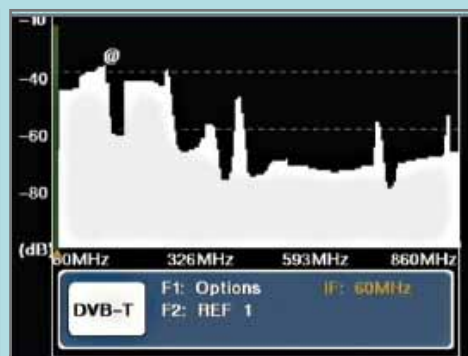
Aktivní frekvenci lze snadno rozeznat pomocí spektrálního analyzátoru!
