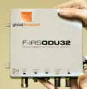
■ Samantha Bransgrove pracuje u Global Invacom v marketingu; zde nám ukazuje jeden z prvních prototypů F-IRS ODU32. Sem jsou zapojeny koaxiální kabel z F-IRS LNB a kabel z antény pro pozemský příjem. Dva optické výstupy slučují satelitní TV a DTT signály.
