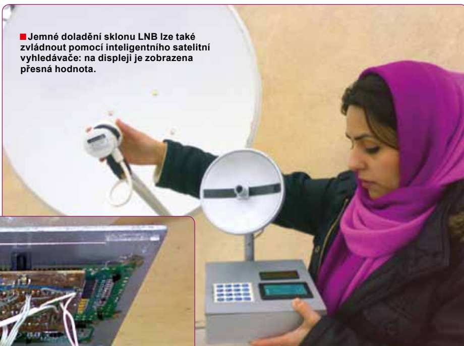
■ Takto se satelitní vyhledávač používá - ukazuje polohu družic, které je možno zaměřit a k němu je připojena skutečná anténa.
