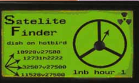
■ Displej inteligentního vyhledávače zobrazuje nejsilnější transpondéry spolu se skolem LNB.
