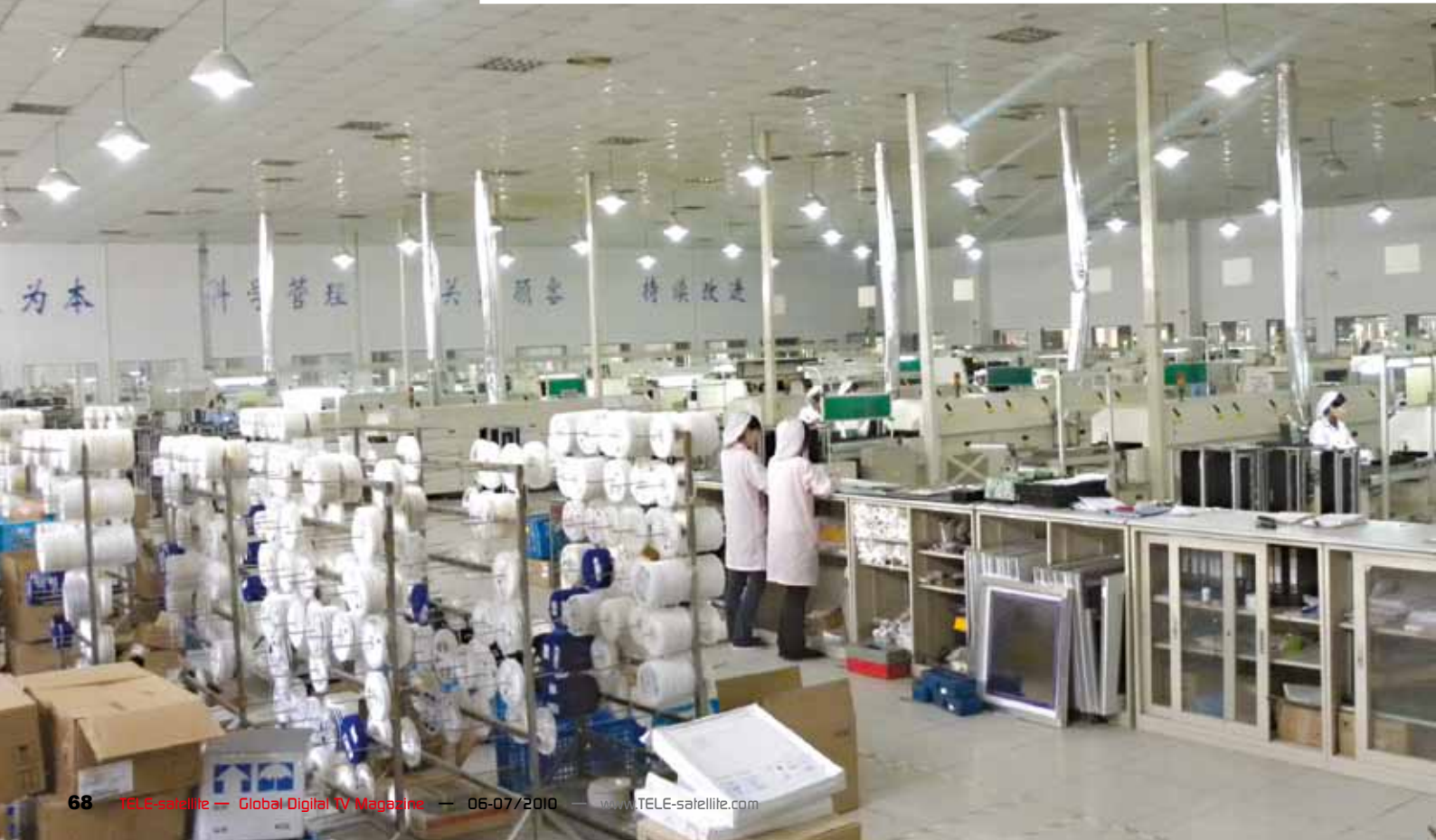
■ Na druhém konci jsou role s materiálem pro povrchovou montáž. Zaměstnanci je průběžně doplňují do automatů. SMT automaty běží 24 hod denně. Čínský nápis na zdi v pozadí zní: "Spolupráce s kolegy, dobrý management, orientace na zákazníka, neustálé zlepšování."
