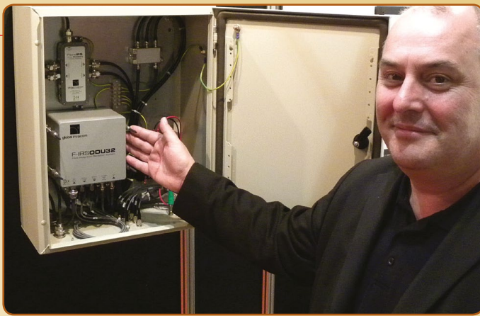
■ Novinka od GlobalInvacom: jednotka se čtyřmi spojenými ODU32, které poskytují osm identických optických výstupů, schopných připojit až 256 koncových bodů
